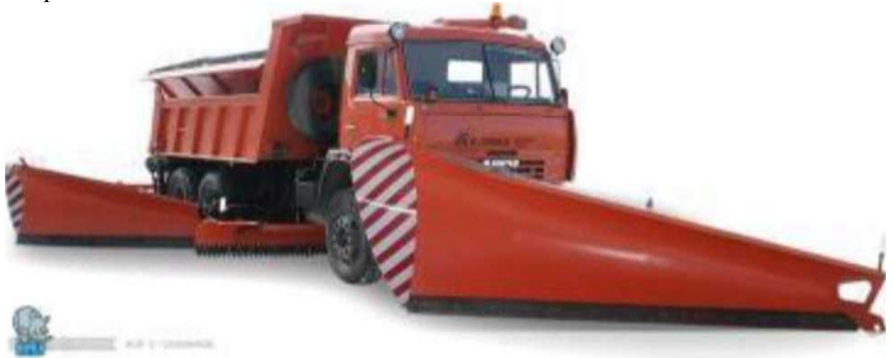
Рисунок 7.2 - ДМК 40.02 с передним, средним и боковым отвалами
